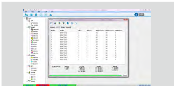
路径参数： 16段路径程序编写。进行位置、速度、回原点等多种运动控制程序的具体参数设置；
