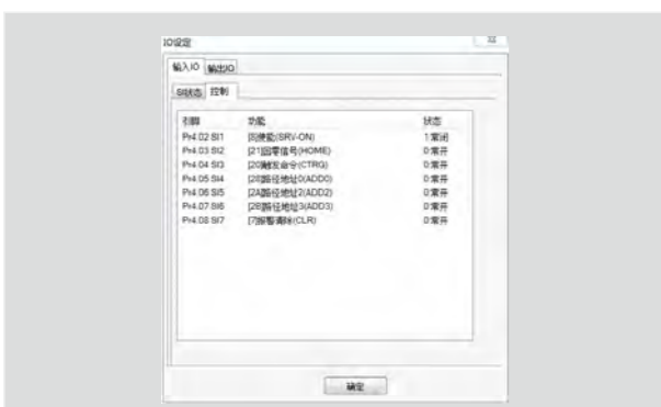
IO设定： 输入输出功能设定
