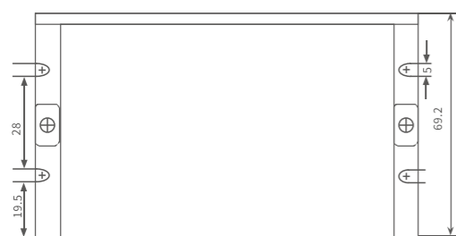
DM442-IO-24安装尺寸图(单位:mm)
