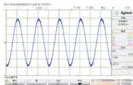
图6 57CM23电机在60rpm时的绕组电流波形
