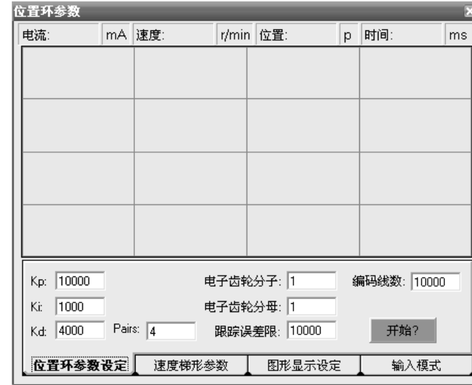
图 5 电机极对数和编码器线数
