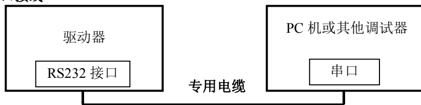
图 6 参数调试接线原理图
