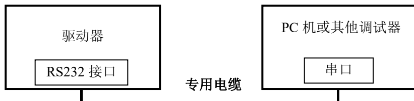
图 6 参数调试接线原理图
