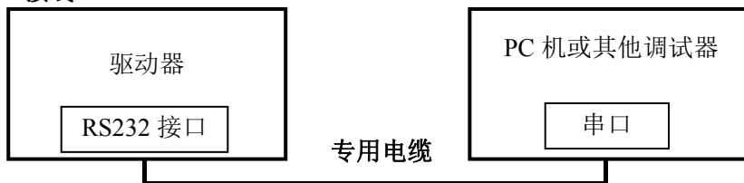
图 6 参数调试接线原理图
