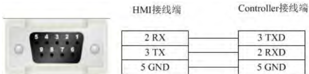
Modbus RTU Server 系列 RS485-2 电缆
