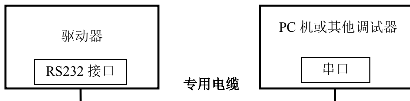
图 5 参数调试接线原理图
