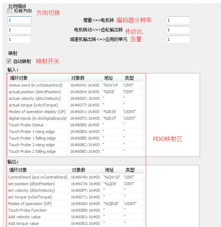
图 6.18 DSP_缩放/映射设置
