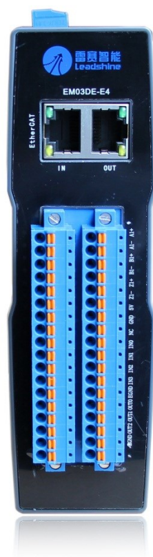
图 2.1 EM03DE-E4 EtherCAT 高速计数模块外观图
