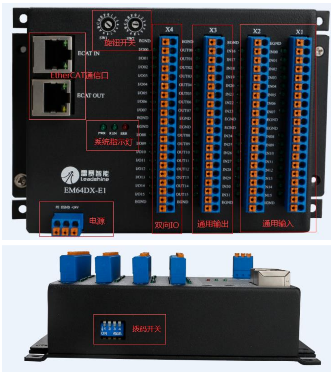
图 2.2 EM64DX-E1 硬件接口分布图
