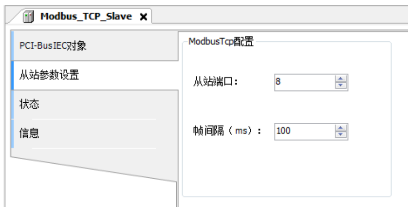
图4.53 Modbus TCP从站配置
