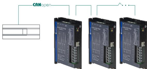
LD2-CAN系列支持CAN总线，采用抗振动态能更强的molex端子，只需一根通讯线即可实时传递驱动器的指令、以及电机/驱动器等的状态反馈信息。
