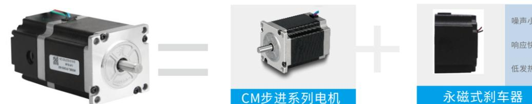
CM系列防水型步进电机,与标准型相比,后端盖重新设计,引出线改用防水连接器,前后端盖与机身之间增加了新型密封材料,电机机身做了全面的防水处理,电机轴端选用了优质油封,使得整机的防护等级达到了IP65。可适用于各类潮湿、淋水、户外、油液飞溅的场合。
