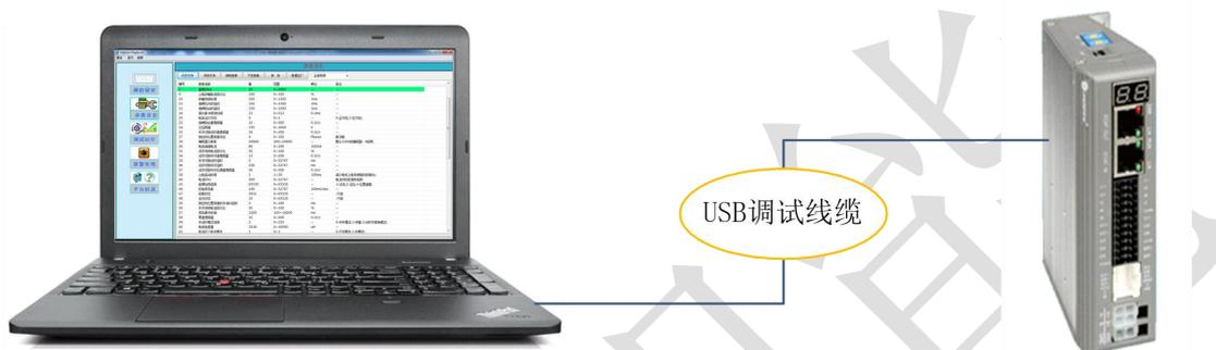
图 4-2 驱动器与 PC 的连接示意图
