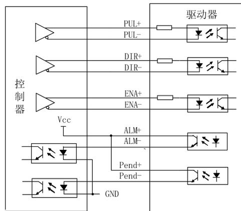
差分方式控制信号接口接线图
