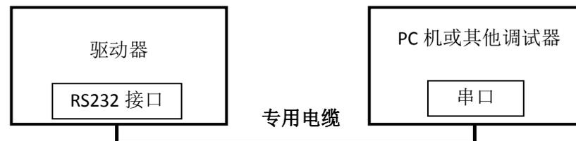
图 6 参数调试接线原理图
