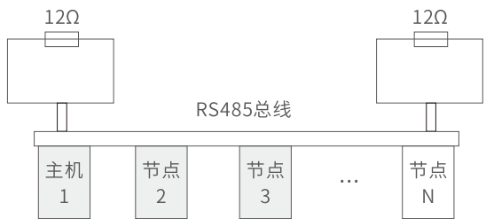
图7-5 终端电阻的正确接入方式
