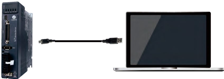
图7-1 调试连接示意图
