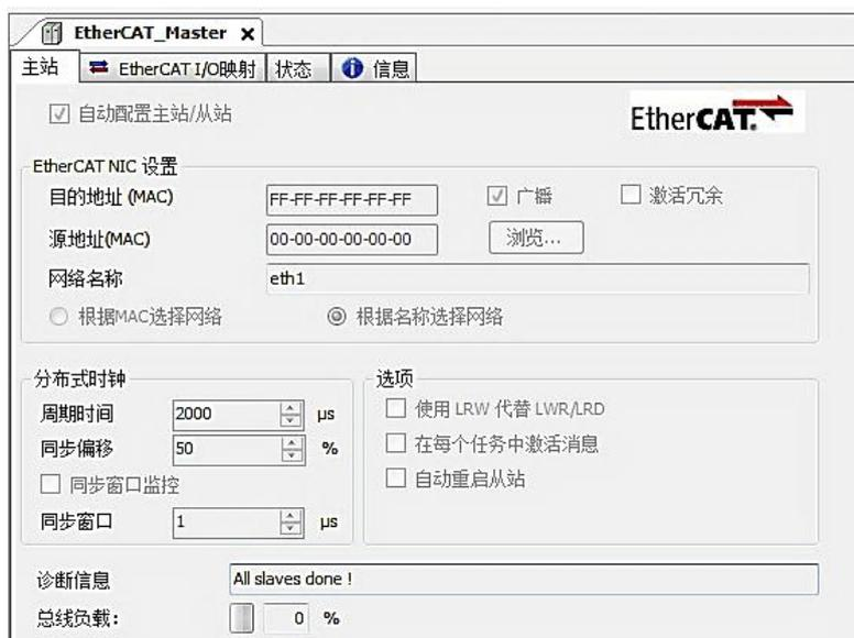
图 5.6 在线模式显示诊断信息
