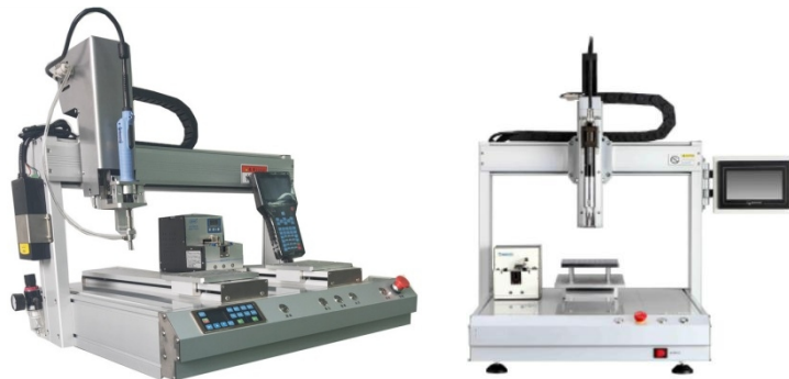
图 1 常见的自动锁螺丝机
